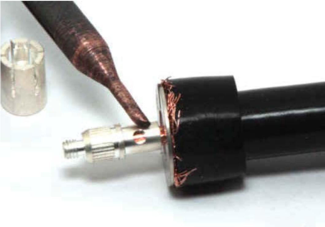
Schieben Sie die Massehülse bis an die Außenhaut. Die Gummidichtung wird bis an den Massehut gedrückt. Überhängendes Kupfergeflecht wird abgeschnitten.
