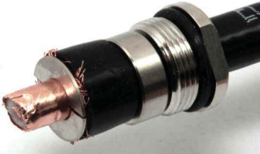
Schieben Sie die doppelt geschlitzte Massehülse zwischen die Kupferfolie und das Geflecht.
