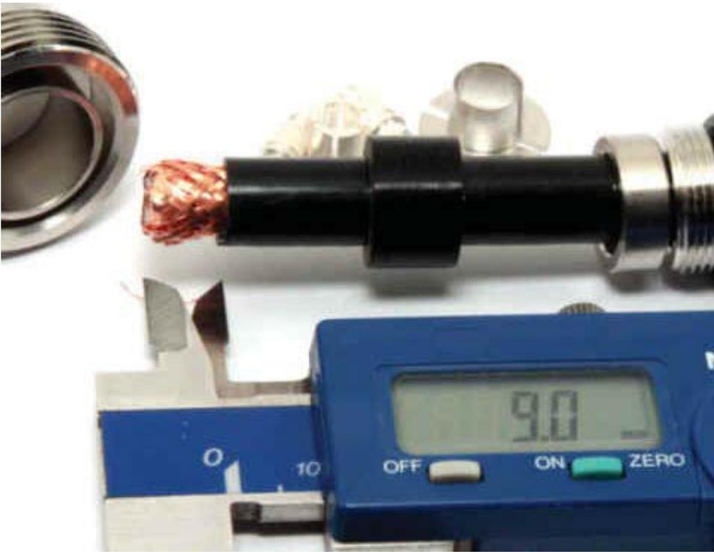
Setzen Sie die Spanschraube, den Anpressring sowie die Gummidichtung auf das Kabel. Schneiden Sie etwa 9 mm von der Außenhaut, wie es auf Bild 2 ersichtlich ist.
